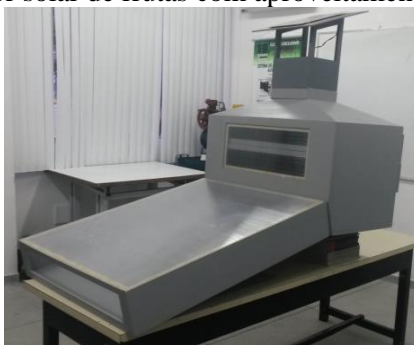
Figura 1 - Secador solar de frutas com aproveitamento multienergético.
